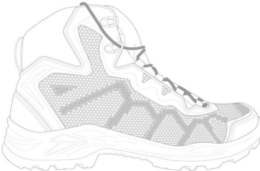
Рисунок 6.1 – Орієнтовне зображення розміщення сот / Figure 6.1 – Approximate image of honeycomb placement
