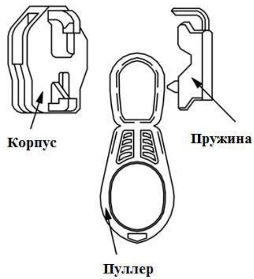
Рисунок Д4.3 – Схематичне зображення замка з 3-х деталей
